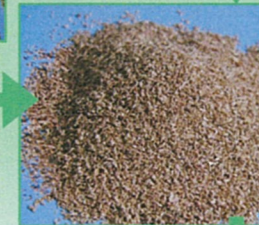
加工后的软木树皮和制取软木塞时剩下的材料加工成软木颗粒。
